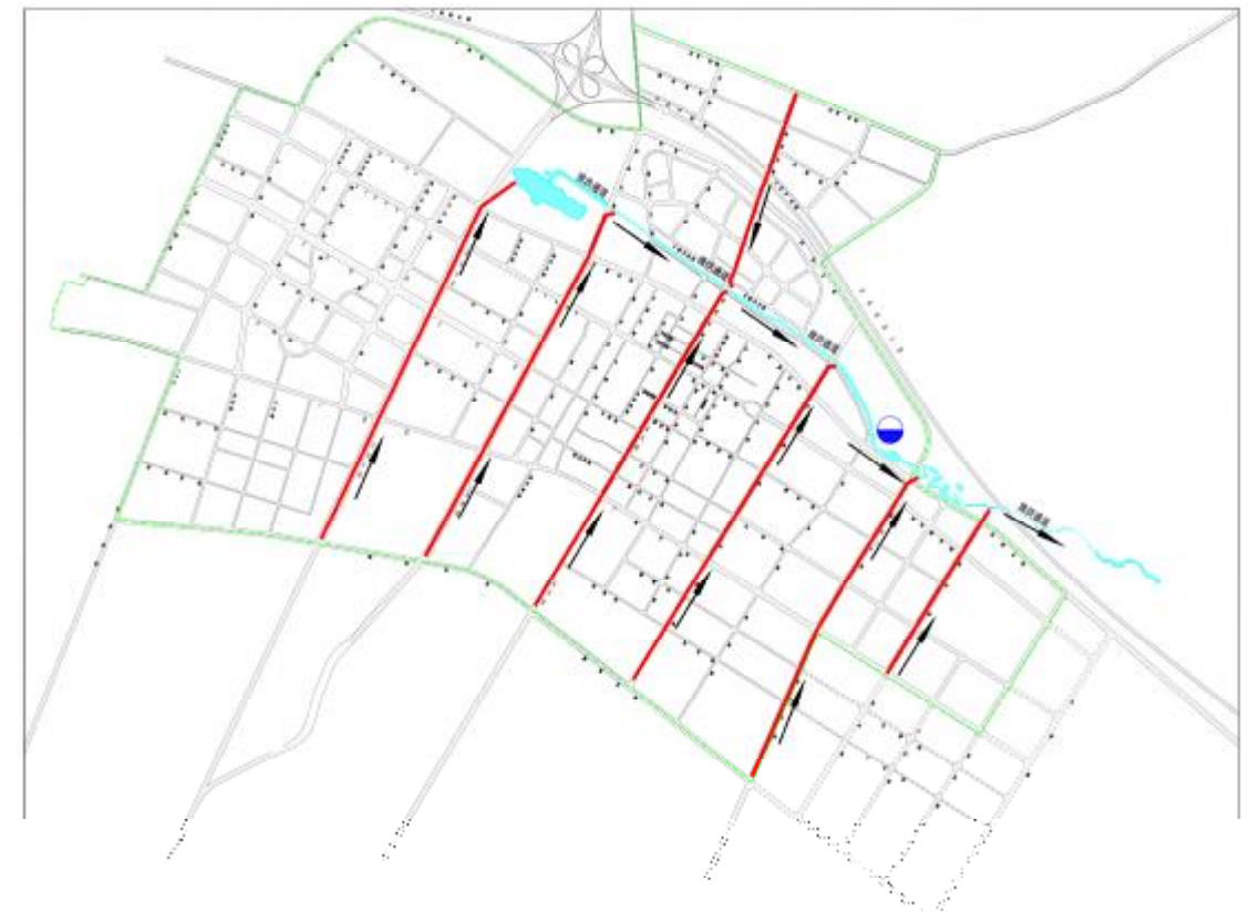
图 10-1 雨水出路示意图
